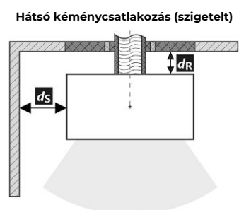
A füstcső áthaladása éghető anyagból készült falon
