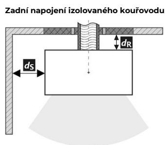
Prostup kouřovodu stěnou z hořlavé hmoty ČSN 06 1008
