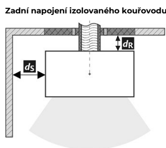
Zadní napojení izolovaného kouřovodu
