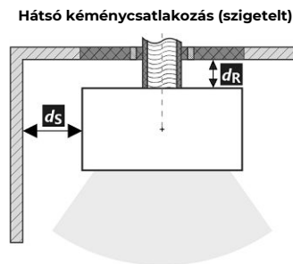
A füstcső áthaladása éghető anyagból készült falon
