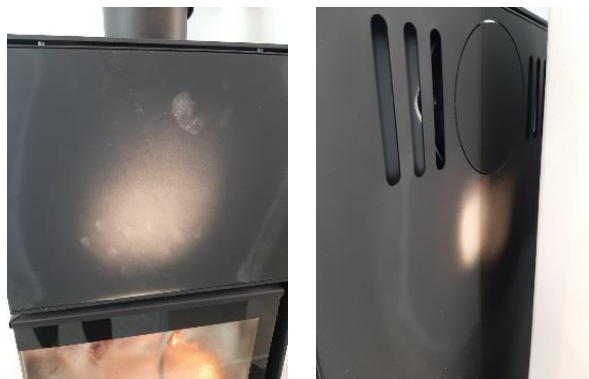
Rysunek 9. Przykłady przebarwień powstałych w wyniku przegrzewania urządzenia.
