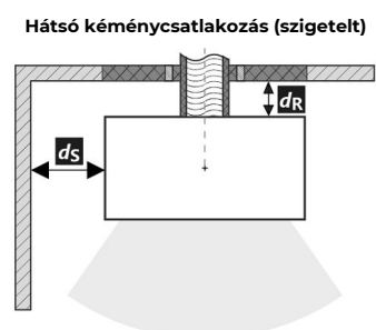
A füstcső áthaladása éghető anyagból készült falon
