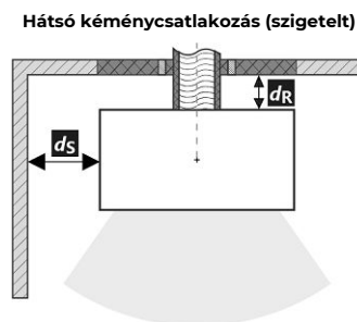
A füstcső áthaladása éghető anyagból készült falon
