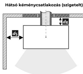
A füstcső áthaladása éghető anyagból készült falon
