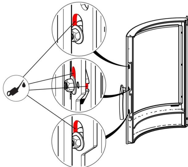
**Mazání pantů:** (čep mazat v místě třecích ploch s pantem)
